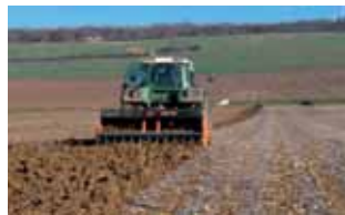
Вігнуті рухомі зуби для твердих сухих ґрунтів.
